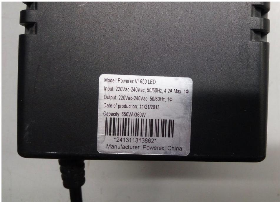
Для ИБП POWEREX VI 650 LED заявлена полная мощность 650 Вольт-Ампер, активная – 360 Ватт. Сравните при этом размеры трансформатора этого ИБП с размерами трансформатора ТС-360М от старого доброго советского телевизора, который мог работать бесконечно)))
