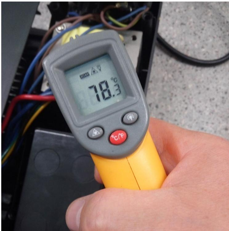
Температура трансформатора после работы в батарейном режиме.
