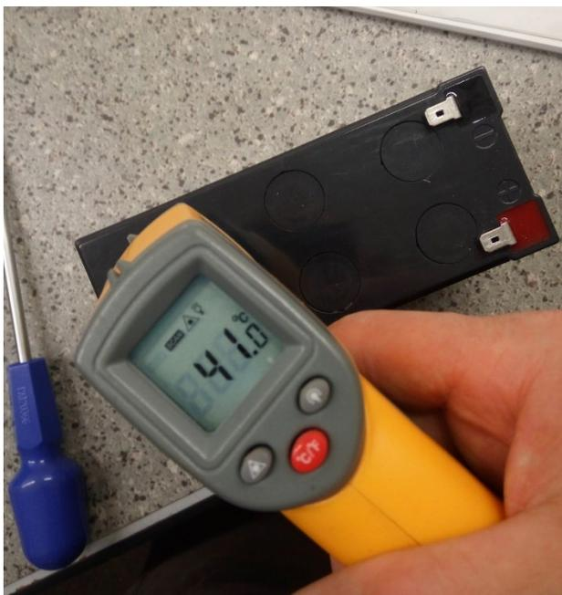
В общем, батареи в дешевых линейно-интерактивных ИБП, где АКБ стоит в одном отсеке с трансформатором и силовой платой, не имеющих вентилятора, обречены изначально... Как не вспомнить здесь знаменитое «Белорусы будут жить плохо, но недолго!».
